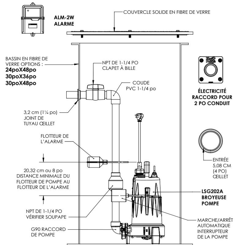
Le système EPAK-LSG n'est pas assemblé. Tous les composants de tuyauterie internes sont illustrés dans le schéma ci-dessus inclus avec le système.
